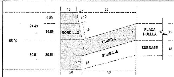
Ilustración 1 Detalle de las cunetas y bordillos
