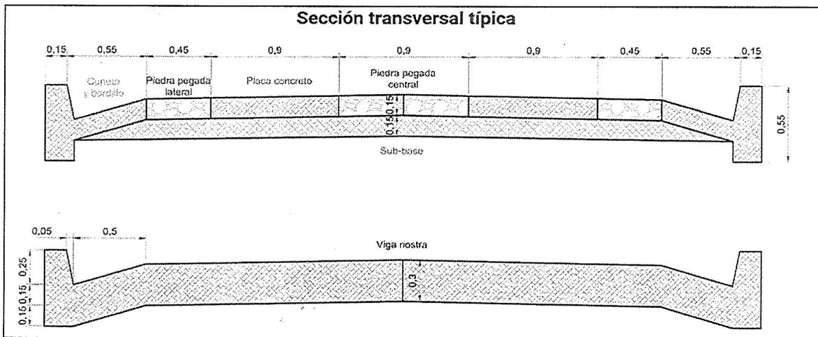
Ilustración 2 Detalle de la estructura a construir
