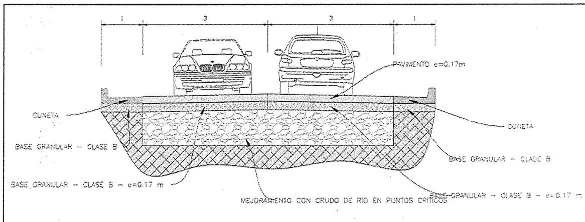
Ilustración 1 Detalle de la estructura de pavimento a construir
